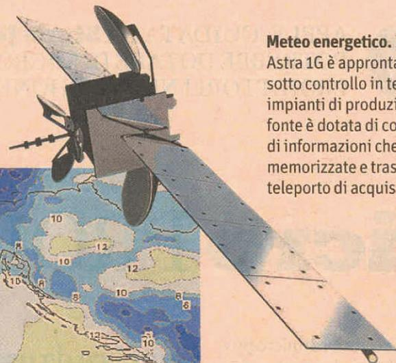
**Meteo energetico.** Il satellite Astra 1G è approntato per tenere sotto controllo in tempo reale gli impianti di produzione: ogni fonte è dotata di concentratore di informazioni che vengono memorizzate e trasmesse al teleporto di acquisizione
